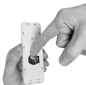
Batterie entfernen und neue Batterie einsetzen.
